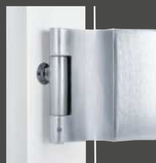
Ausführung GT Justierbandaufnahme 1-dimensional verstellbar bei geschlossenem, eingehängtem Türblatt
