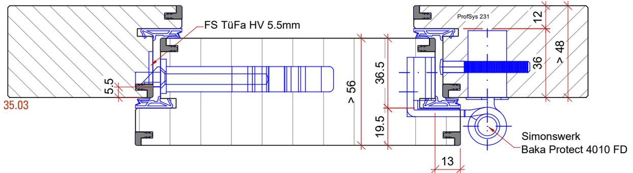
Detail überfält mit Überschlagdichtung mit Band SIMONSWERK VX7939FD
