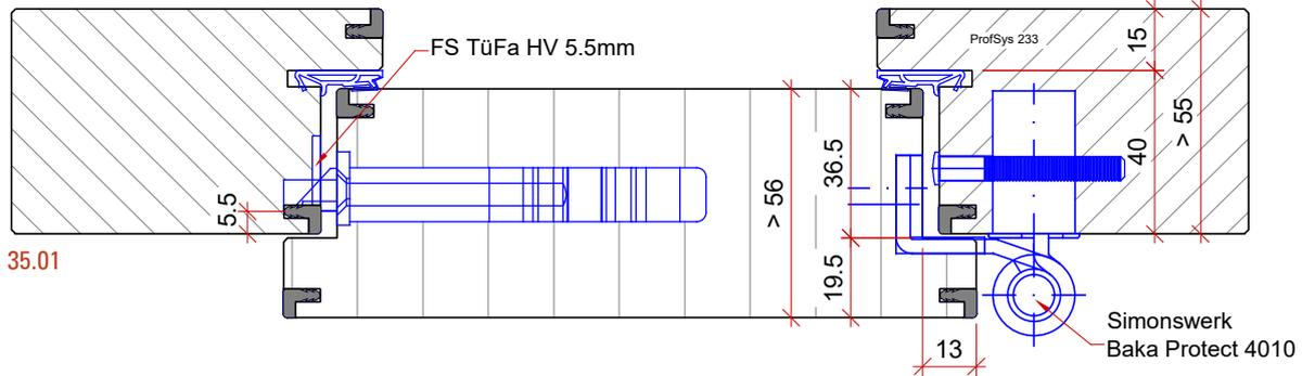
Detail überfält ohne Überschlagdichtung mit Band SIMONSWERK VX7728
