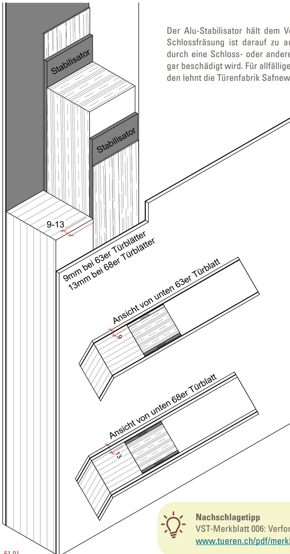
Der Alu-Stabilisator hält dem Verzug der Türe entgegen. Bei der Schlossfräsung ist darauf zu achten, dass der Stabilisator nicht durch eine Schloss- oder andere Beschlägefräsung touchiert oder gar beschädigt wird. Für allfällige Beschädigungen seitens des Kunden lehnt die Türefabrik Safnewil AG jede Haftung ab.
