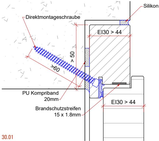
Gefälztes Mauerwerk Montage in Rahmenfläche
