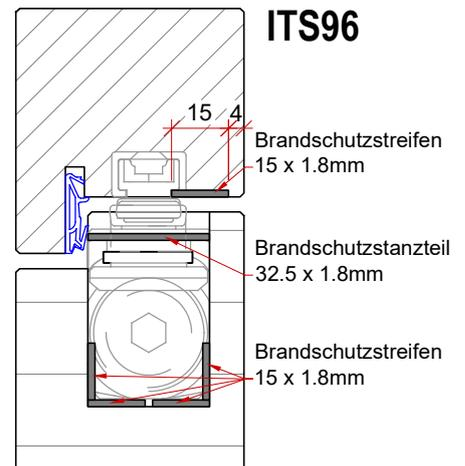
Grundsätzlich muss jedes Brandschutzelement mit der entsprechenden Anzahl und Grösse an Dämmschichtbildnern ausgerüstet sein. Ein Brandschutzelement ohne Brandschutzstreifen ist nicht Brandschutzgeprüft!
