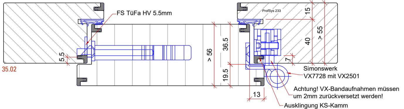
Detail überfält mit Überschlagdichtung mit Band SIMONSWERK BAKA Protect 4010FD
