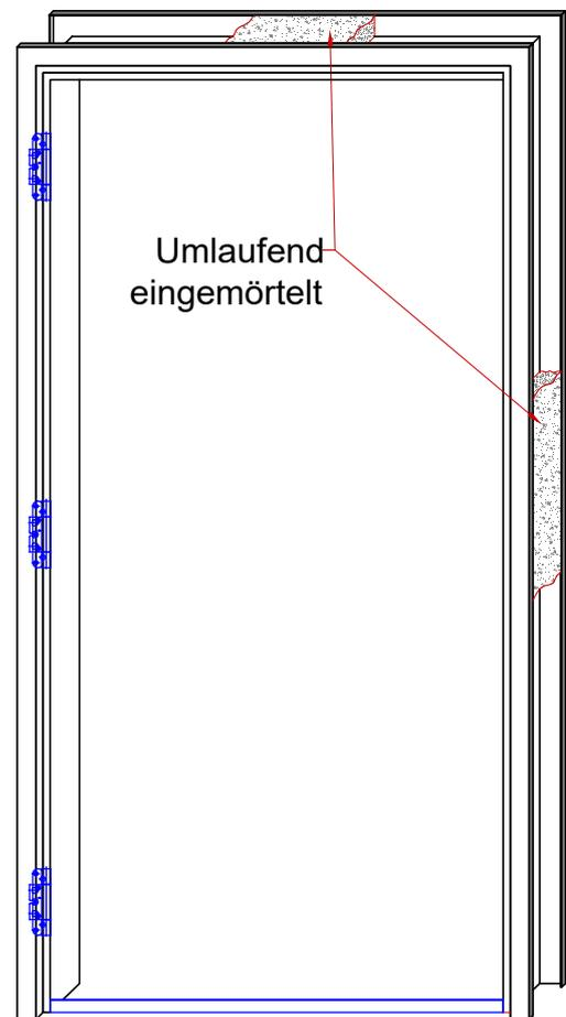
47.04 Die Stahlzargenmontage muss gemäss den Vorgaben des entsprechenden Stahlzargenherstellers ausgeführt werden!
