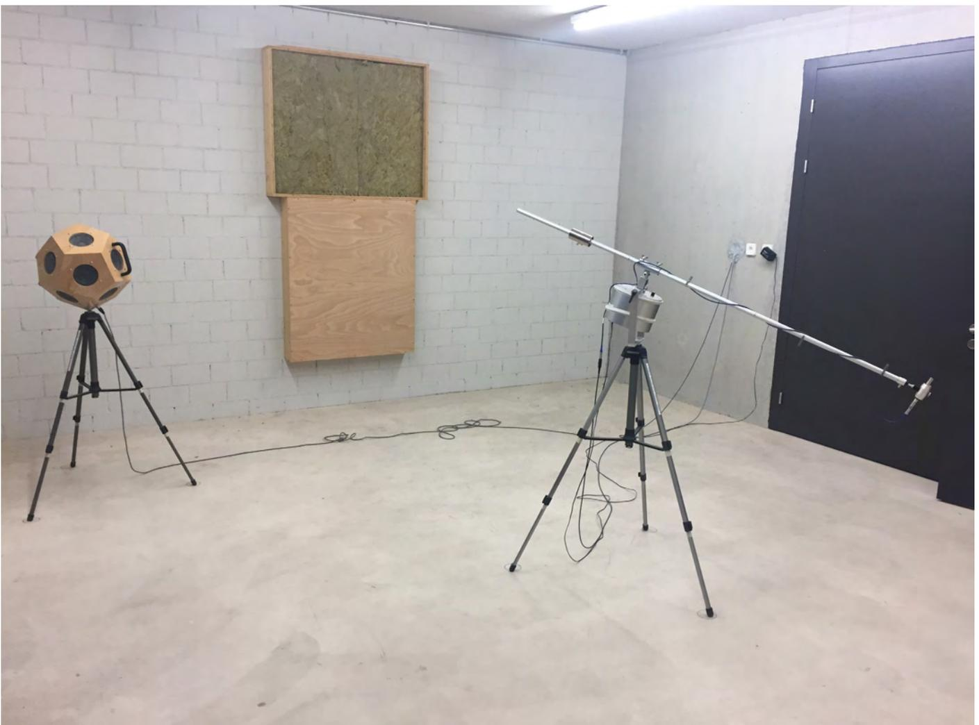
7.01 Prüfsetup im Schallschuttlabor: Links Lautsprecher / rechts Mikrofon
