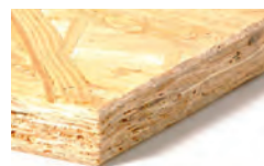
Oriented Strand Board (OSB) z.B. Böden, Wände, Decken, Dach
