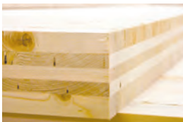
Brettspertholz mind. 3 kreuzweise miteinander verleimte Massivholzplatten
