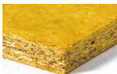
Spanplatten z.B. Wände, Decken, Türen, Möbel
