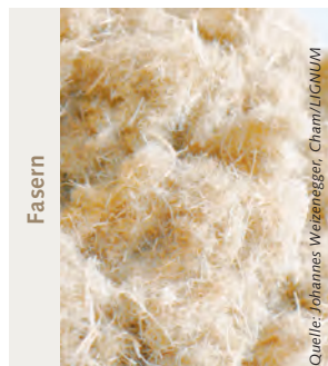
Poröse Faserplatte Wärme- und Schalldämmung
